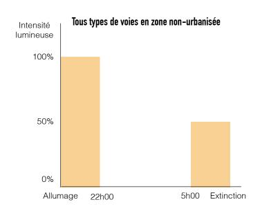
A noter: le scénario proposé présente une contrainte technique dans le choix des appareillages à mettre en place puisqu'il nécessite la mise en place de drivers de variation sur 3 paliers (100%/50%/0%) représentant un surcoût d'environ 10% du prix de la lanterne sur ces secteurs.
